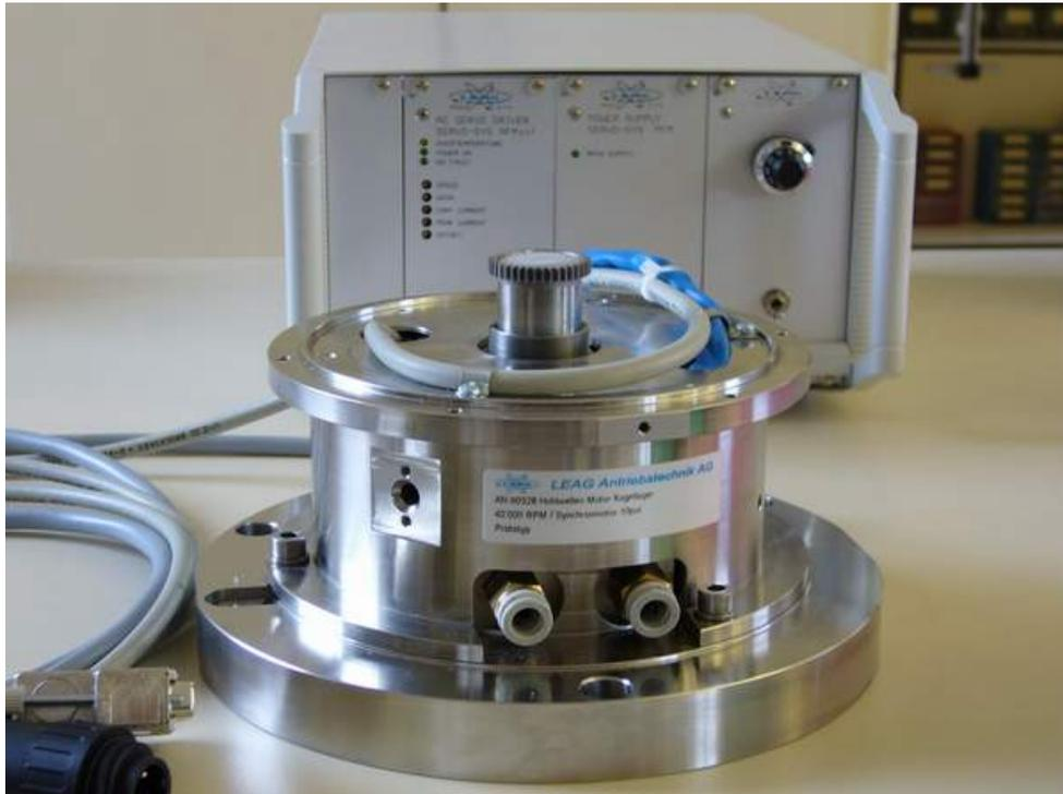
Der Hochfrequenz-Motor wurde von der LEAG Antriebstechnik AG auf der Basis von AC-Servomotoren entwickelt und gebaut.
