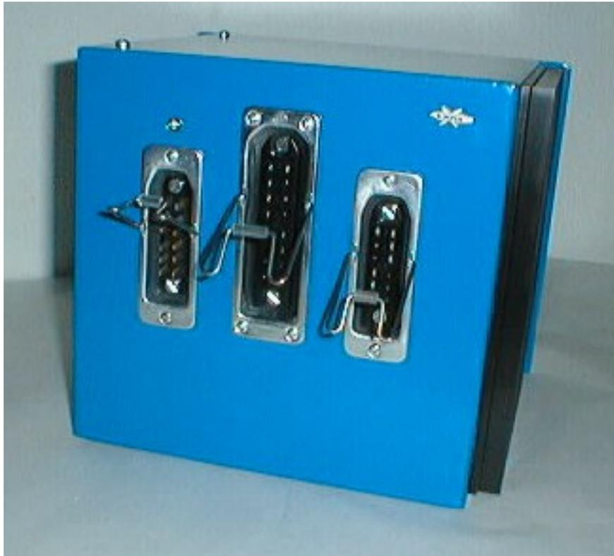
Der Hochfrequenzumformer hat 3 sinuscommutierte Phasen-Ausgänge. Die Steuersignale sind galvanisch getrennt. Drehmoment bei Nullzahl.
